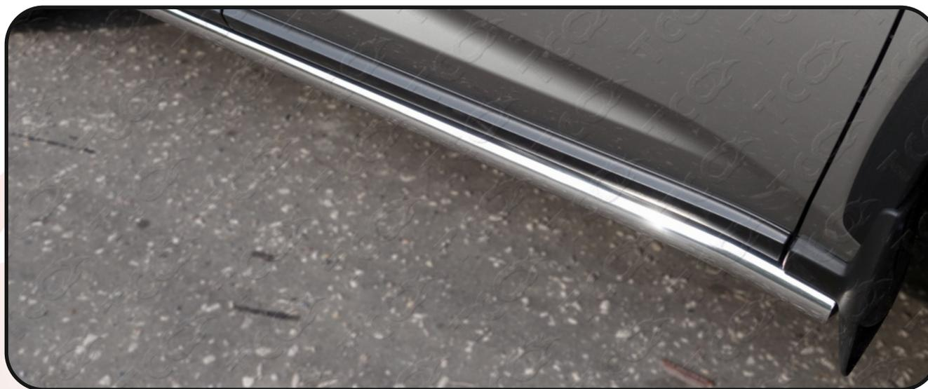
Пороги труба 60,3 мм арт. **LEXNX300H14-14, LEXNX20014-14, LEXNX20015T-14**
