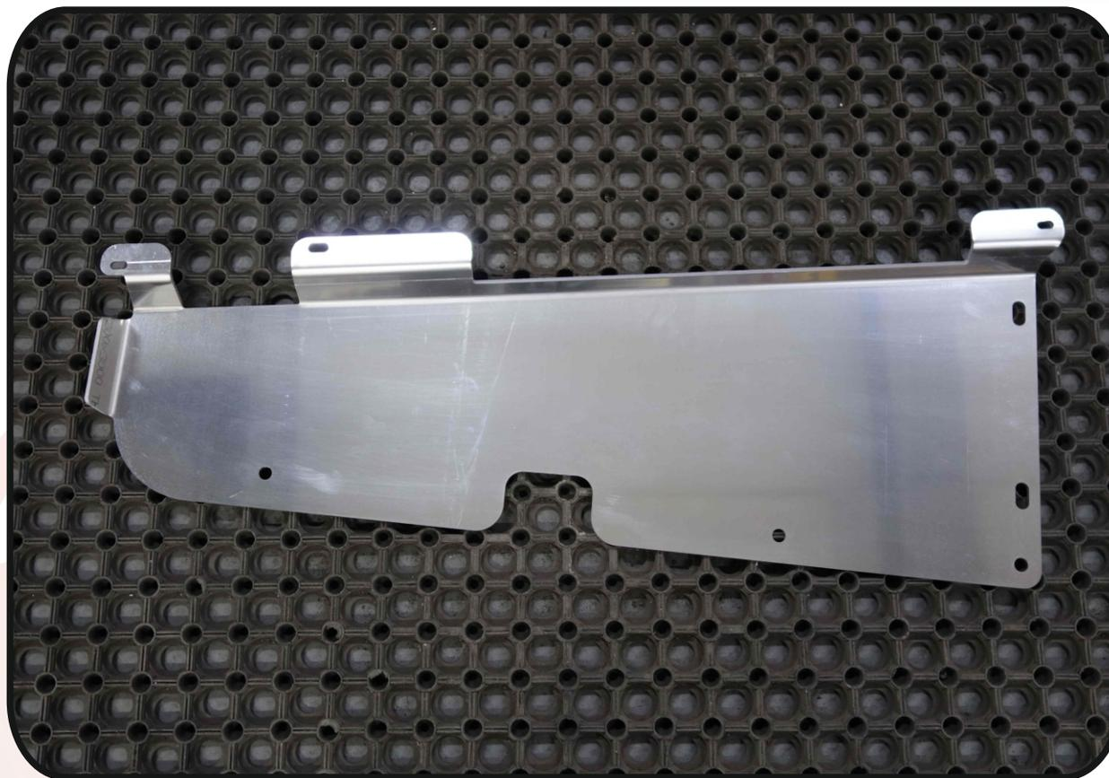
Защита топливопровода (алюминий) 4мм
